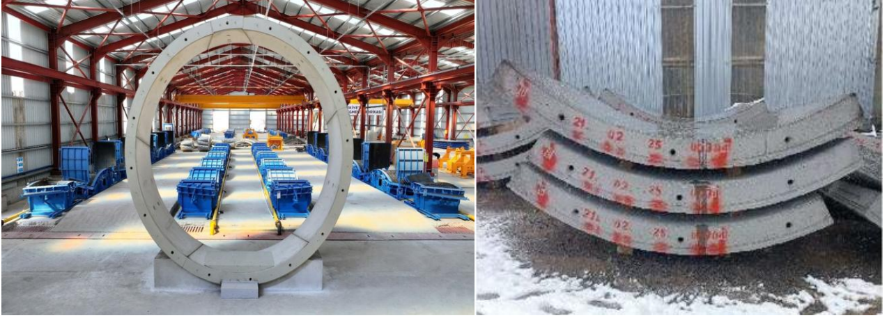
Şekil 3.6 Segment ve Ringlerin Örnek Görünümü
